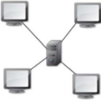
C'est la topologie la plus courante actuellement. Les ordinateurs du réseau sont reliés à un système matériel qui peut être un concentrateur (hub) ou un commutateur (switch). Les nœuds communiquent sur le réseau en faisant passer simplement les données par ce concentrateur ou commutateur. Le câblage du réseau est plus coûteux que celui de la topologie en bus. Il est effectué à l'aide de câble en paires torsadées.
